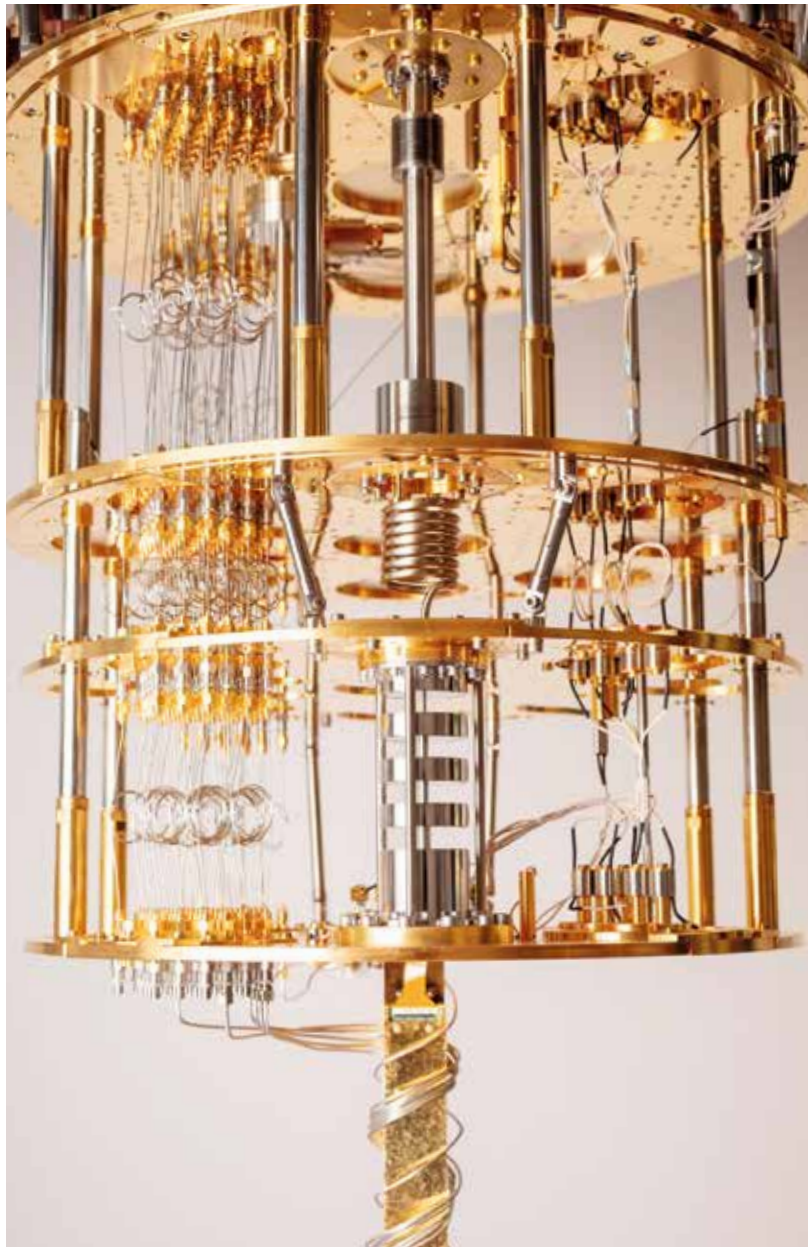
Opstelling bij QuTech/TUD: De binnenkant van een verdunningskoelkast. Het koudste deel bevindt zich onderaan, bij de qubits. De draadbundels aan de linkerkant verbinden de qubits met de meetapparatuur buiten de koelkast.
