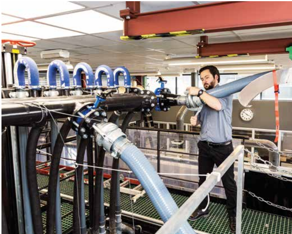
Met een enorme tank onderzoekt promovendus Arash Maghsoudloo (TUD) de zeebodem bij de Oosterscheldekering. Door erosie kunnen gaten en hellingen in de zeebodem ontstaan. Wanneer treedt het fenomeen ‘statische liquefactie’ op en zal de helling gaan schuiven?
