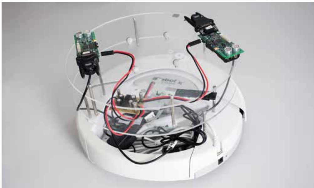
Onderzoek naar gedistribueerde en coöperatieve controlsystemen in het Networked Embedded Robotics Lab van Delft Centre of Systems and Control. Op de foto een iRobot Create, een platform om onder meer te experimenteren met een bekend probleem in de robotica: lokalisatie.
