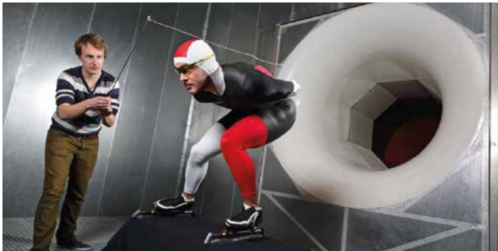
Bij de UT wordt een schaatspak getest in een windtunnel.
