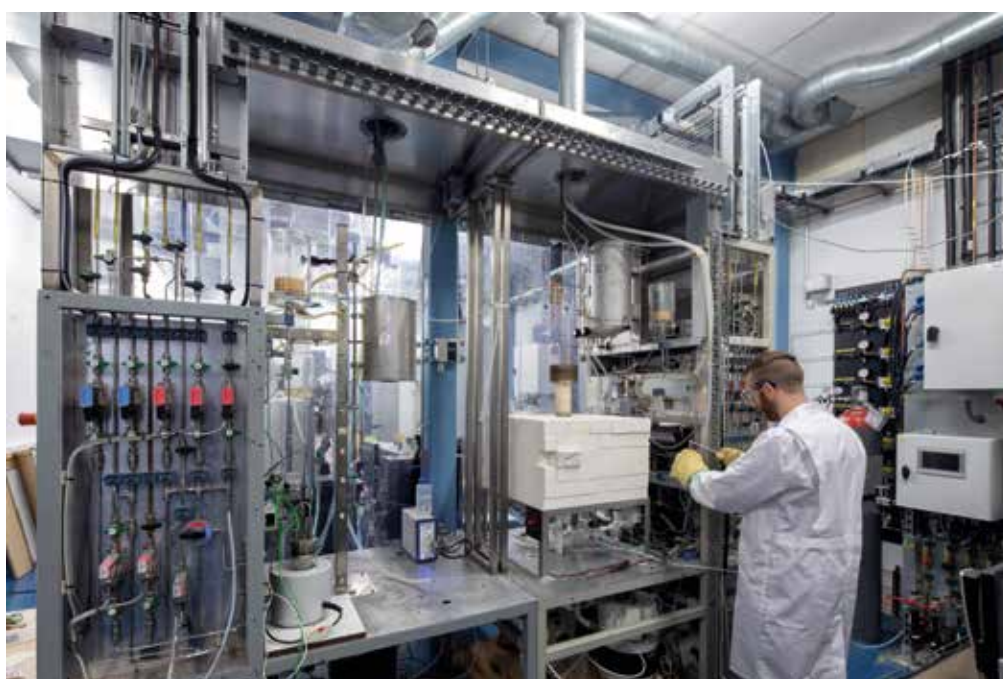
Een hoge temperatuur brandstofcel bij TUD, voor onderzoek naar efficiënte en emissievrije omzetting van brandstof in elektriciteit. De brandstofcel kan ook in reversed mode worden gebruikt om brandstof uit elektriciteit te maken met een hogere energiedichtheid dan bijvoorbeeld batterijen. Foto: TUD/Frank Auperlé
