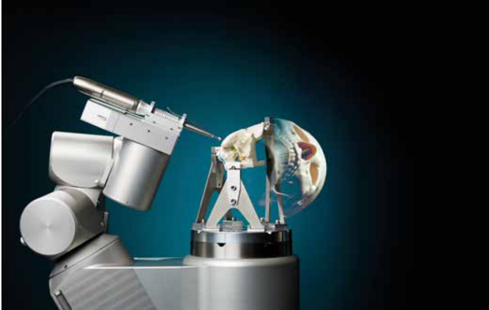
RoBoSculpt, een prototype schedelboorrobot nabij de gehoorgang, een ontwerp van Jordan Bos, promovendus CST Mechanical Engineering, TU/e. Het verwijderen van schedelbot vereist dat chirurgen extreem nauwkeurig werken met beperkt zicht. Deze chirurgische robot voert sub-millimeter botverwijderingstaken uit in de schedel, op basis van CT-scans.
