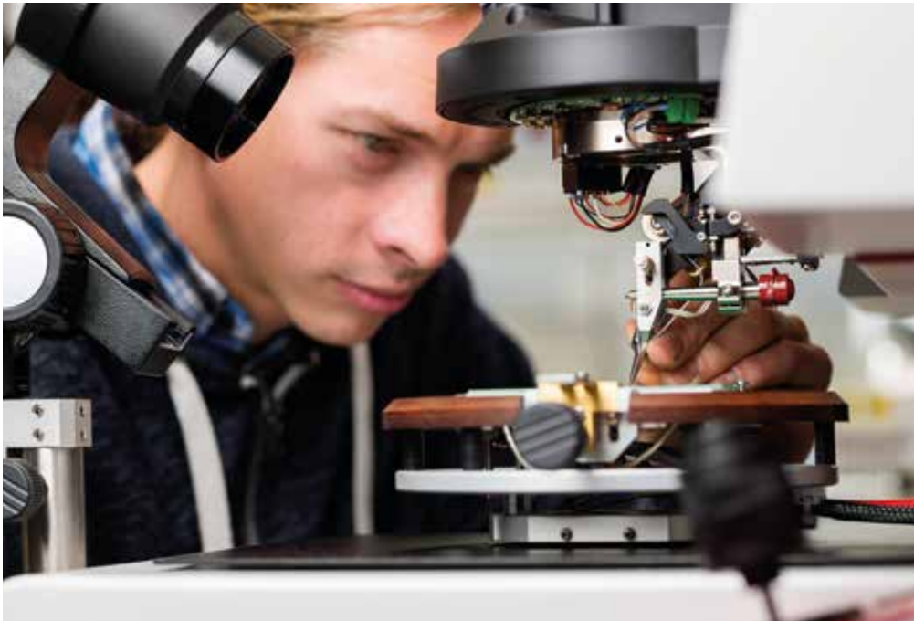
Een technicus van de TUD gebruikt een wire bonding-machine om elektrische verbindingen te maken van een chip naar een printed circuit board.
